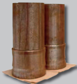
Výrobky po otryskání: vlevo neošetřeno, vpravo ošetřeno VpČI 377
